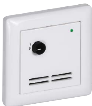
FSTF xx LD2 Исполнение с датчиком, светодиодом (зеленым) и поворотным пере- ключателем (двухпозиционным) (макс. 24 В перем./пост. тока, макс. 130 мА)
