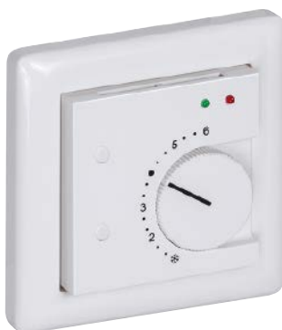
FSTF xx P2L2T Исполнение с датчиком, потенциометром (1 кОм, макс. 0,1 Вт), двумя светодиодами (зеленый и красный) и двумя кнопками (макс. 24 В пост. тока, макс. 10 мА)
