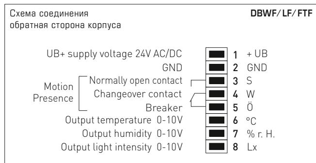
**KINASGARD® DBWF/LF/FTF** Потолочный датчик движения, светочувствительный датчик,
